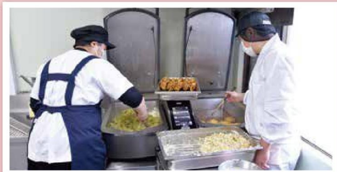
1台で茹でる・焼く・炒める・煮る・揚げの5役をこなし、2槽式で効率良く調理できるバリオクッキングセンター
