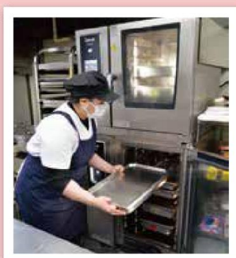
1台で煮物や蒸し物などが同時に出来るスチームコンベクションオープン
